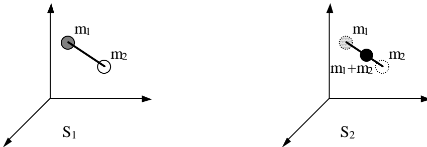
Fig. 4.6: Calculul gradelor de libertate ale unei molecule (a) aplicarea Teoremei lui Lagrange (b) aplicarea Teoremei Centrului de Masă
