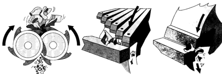
Fig. 5. Dispozitive de tăiere pentru reducerea probei - zdrobitor, tăietor transversal și paralel
