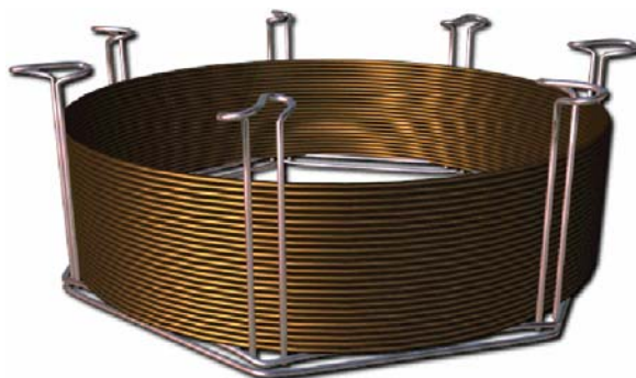
Fig. 10. Bobină de coloană capilară în forma care se folosește în gaz-cromatograf
